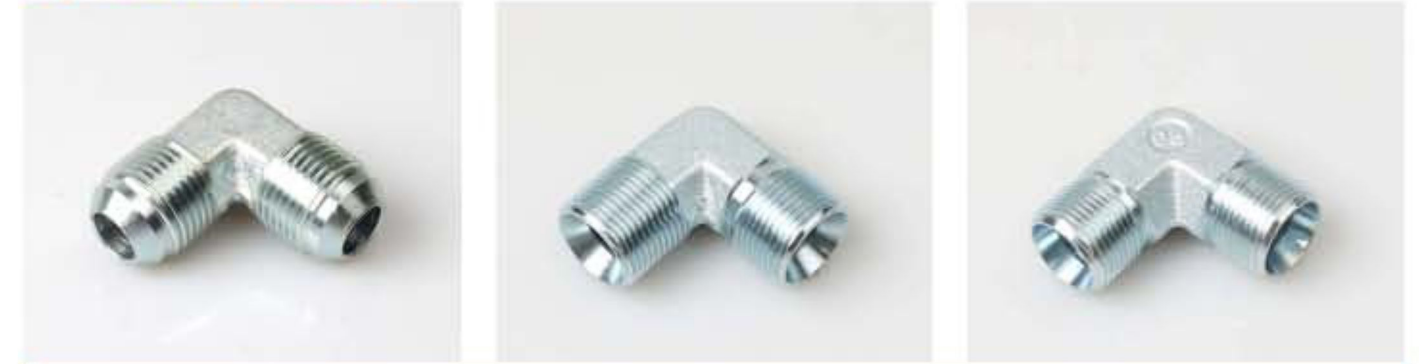
PART NO:1J9 90° Elbow JIC Male 74° Cone PART NO:1BT9 90° Elbow BSP Male 60° Seat/BSPT Male PART NO:1C9 90° Metric Male 24° Cone Seat L.T./H.T.
